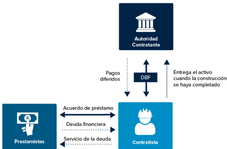
FIGURA 1.3: Esquema Básico de una Estructura de Diseño, Construcción y Financiamiento (DBF)
