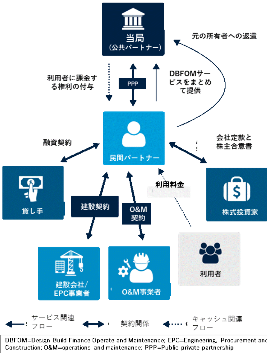
図 1.5 : DBFOM 契約ストラクチャーの基本スキーム (利用者支払型)
