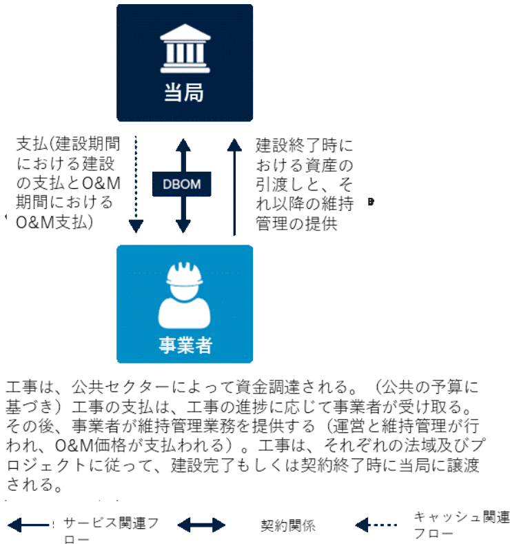
図 1.4：設計・施工・運営および維持管理（DBOM）ストラクチャーの基本スキーム
